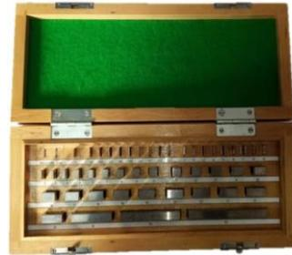
Generalmente se presentan por juegos de un número variable de piezas y gracias al fino acabado de sus caras de medida se pueden adherir entre sí mediante un simple deslizamiento manual, combinándose en la cantidad necesaria para disponer de cualquier valor nominal existente dentro de su campo de utilización, con escalonamientos de hasta 0,5 micras.
